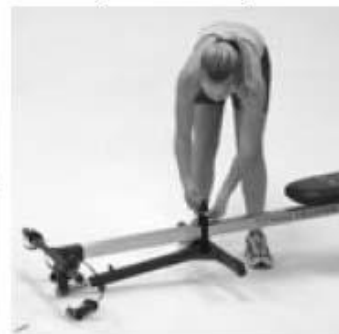
оберните ремень-подпругу с липучкой вокруг стойки и монорельса
